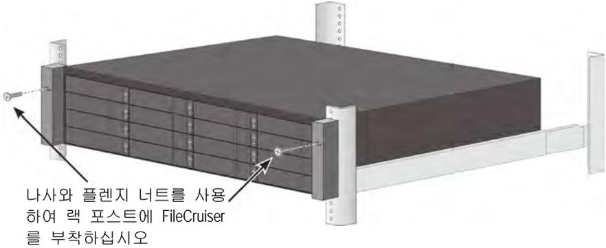
그림 7: 랙에 시스템 설치
