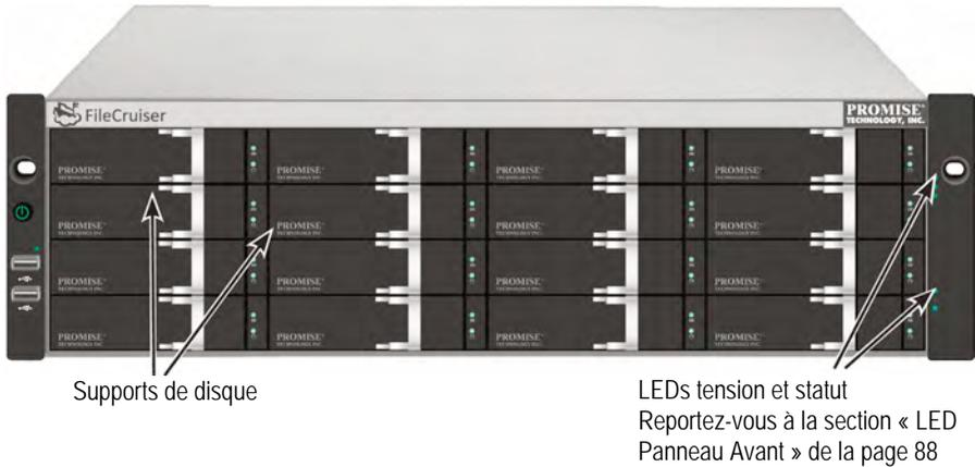
Un disque défectueux peut être remplacé sans interruption de la disponibilité des données pour l'ordinateur hôte. Le lecteur autonome basé sur le matériel RAID logique fournit une performance maximale dans un boîtier externe compact.
