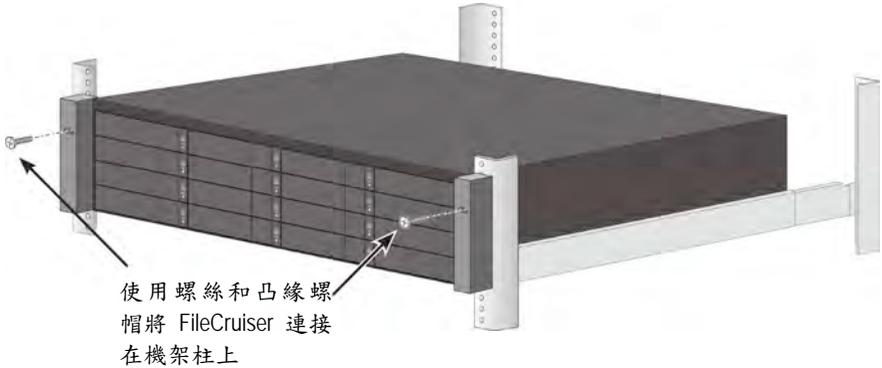
圖 7：安裝在機架中的系統
