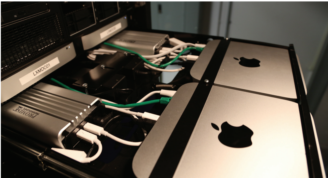
VTrak J930s と NBC の Mac mini を接続する PROMISE SANLink Thunderbolt 対応のファイバーチャンネルブリッジ
