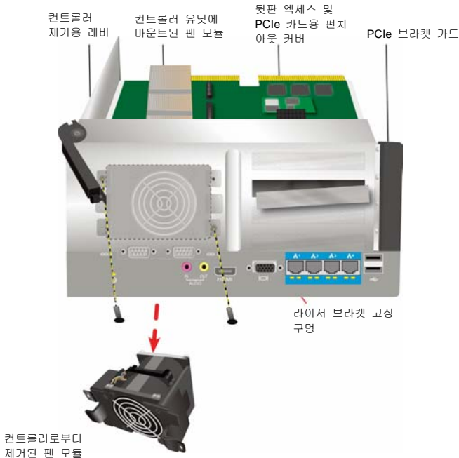
그림 32: Vess A2600 컨트롤러 모듈 - 팬 제거
