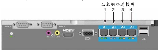
圖 14：Vess A2600 後側面板的 Ethernet 連接埠
