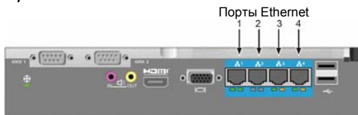
Рисунок 14: Порты Ethernet на задней панели Vess A2600
