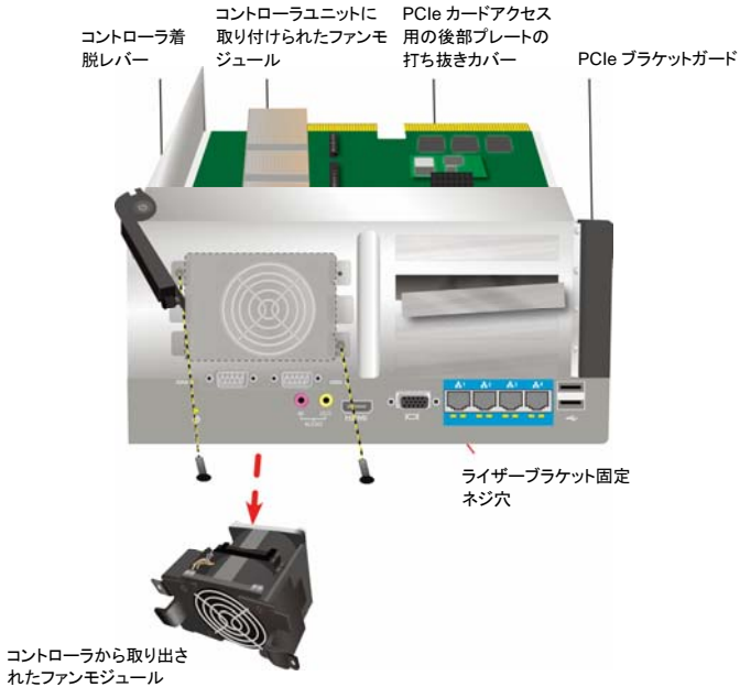
図 32: Vess A2600 コントローラモジュール ファンを取り外し
