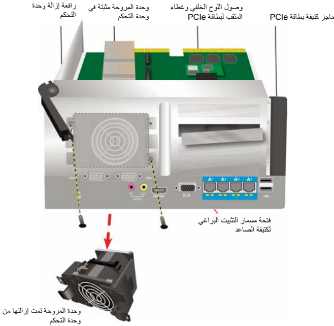
الشكل 32: إزالة المروحة من وحدة التحكم لجهاز Vess A2600
