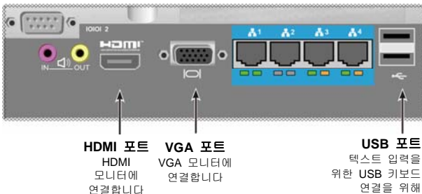
그림 23: Vess A2600 후면 패널의 USB, HDMI 및 VGA 인터페이스
