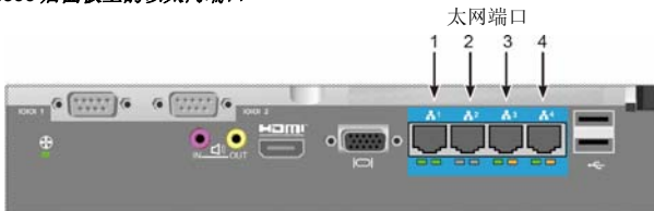
图 14：A2600 后面板上的以太网端口
