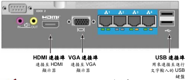
圖 15：Vess A2600 視訊監視器連線及 USB 連接埠
